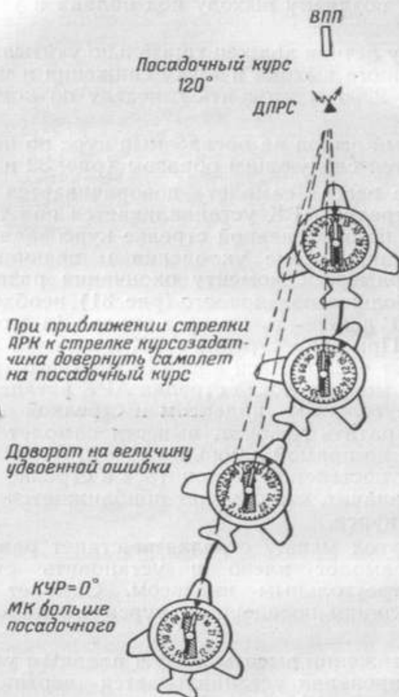
Рис. 32. Исправление ошибки при выходе на посадочный курс ( КУР = 0^\circ , МК > МК_{\text{пос}} )
