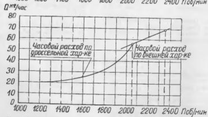
Рис. 30. Внешняя и дроссельная характеристики двигателя АИ-14Р.
