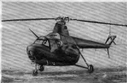
Фиг. 6. Вертолет Ми-1А. Вид 3/4 спереди слева с дополнительным бензобаком.
