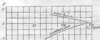
Фиг. 61. Зависимость угла скольжения вертолета от скорости полета на режимах набора высоты и самовращения при полете без крена ( \beta^0=0 ).
