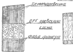
Рис. 26. Сечения заднего лонжерона консоли.
