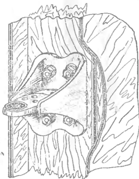
Рис. 4. Нижний узел крепления Р. Н.
