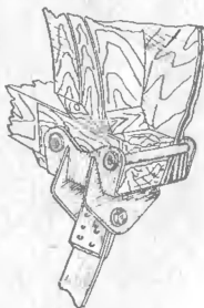
Рис. 10. Узел крепления водорадиатора.
