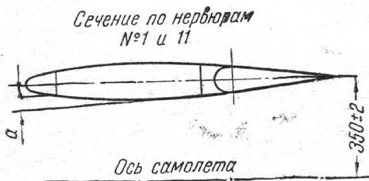
Фиг. 37. Установка стабилизатора.
