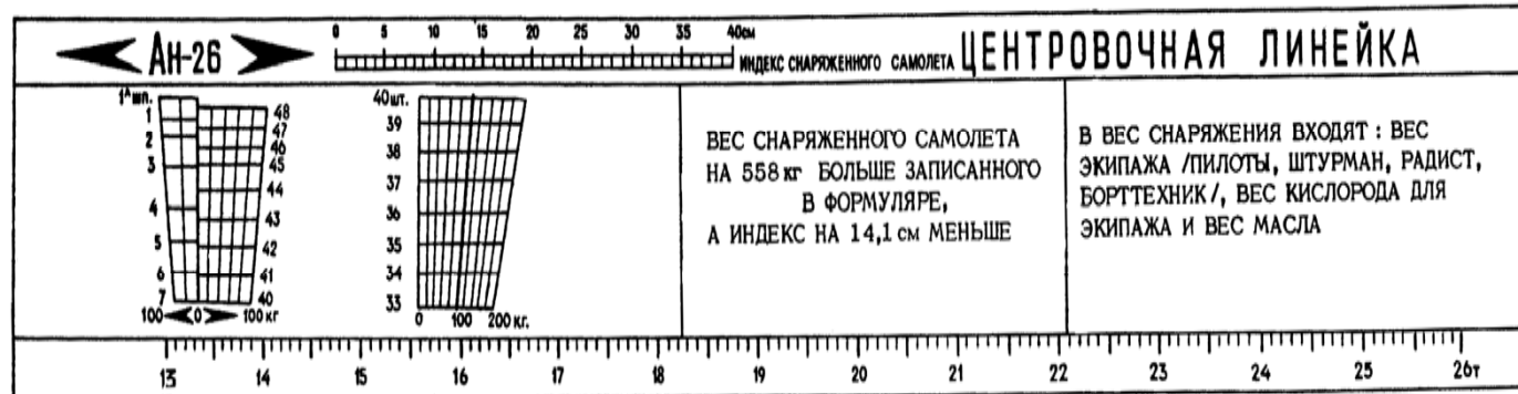
Рис. 2.8. Лицевая сторона линейки при перевернутом движении
